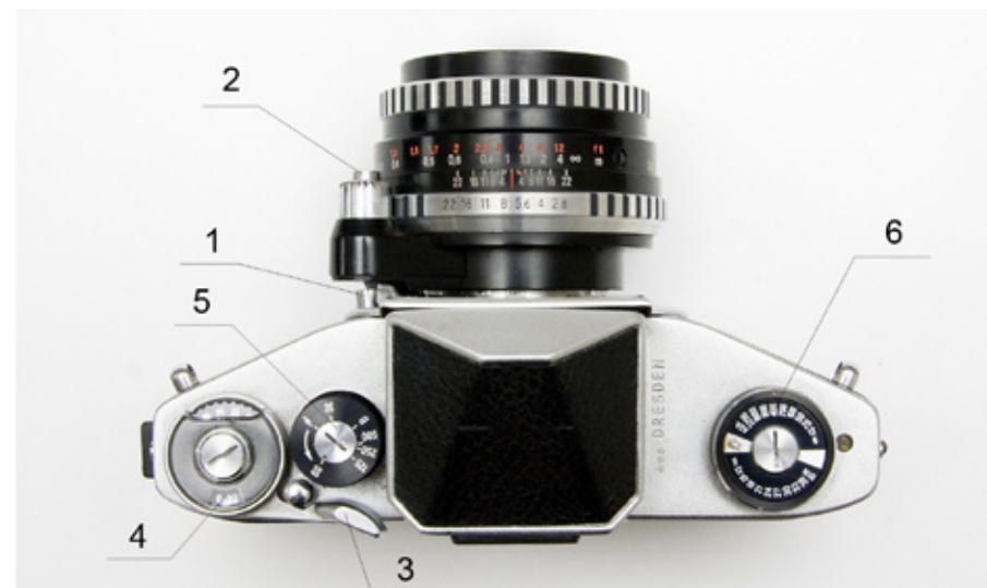
1. - Spust migawki. 2. - Spust migawki umieszczony na korpusie obiektywu. 3. - Dźwignia naciągu migawki. 4. - Licznik klatek. 5. - Pokrętko czasów naświetlania. 6. Wskaźnik czułości filmu.
