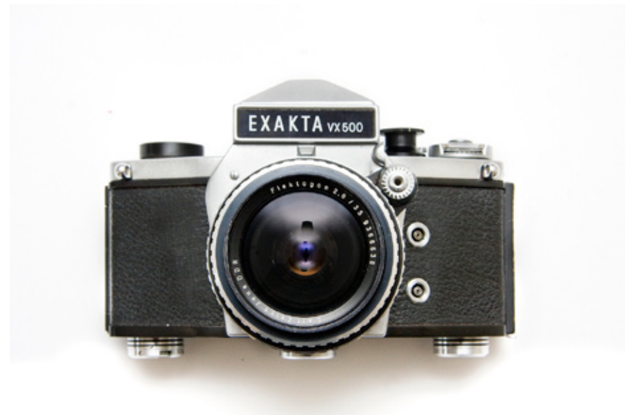
Exakta VX-500 w całej okazałości. Powyżej gniazda lampy błyskowej wyraźnie widoczny nietypowo umieszczony spust migawki
