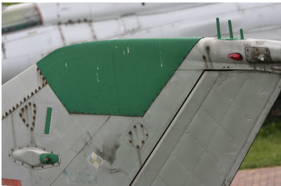
Zdjęcie górne pokazuje detal MiG-a 21 (antena systemu swój-obcy), zaś dolne jego położenie na stateczniku pionowym. Bardzo często spotykanym błędem w publikacjach modelarskich jest pokazywanie detali maszyn w zbliżeniu bez ukazania na ogólniejszym ujęciu ich umiejscowienia na płatowcu.
