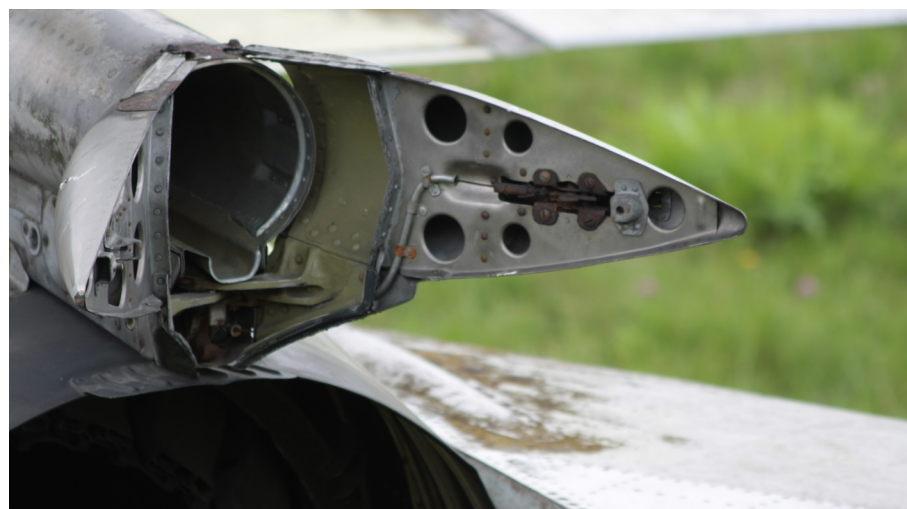
Otwarty luk spadochronu hamującego samolotu MiG-21
